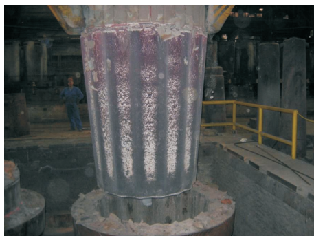
45-tonski ingot po strjevanju, stripanje z mostnim dvigalom
