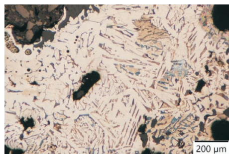
Mikrostruktura pridobljenega volka feritno perlitna mikrostruktura
