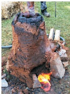
Peč na volka, izpust žindre in pogled v notranjost založene peči
