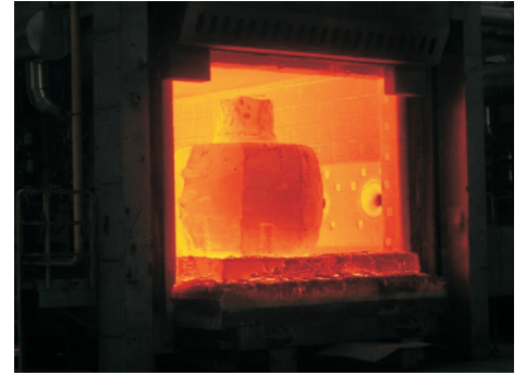
Ogrevanje nakrčenega 45-tonskega ingota pred končnim kovanjem
