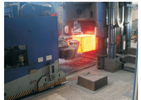
Končno kovanje izdelka iz 45-tonskega ingota jekla za plastiko UTOPNIN izmer 1310 x 1010 mm
