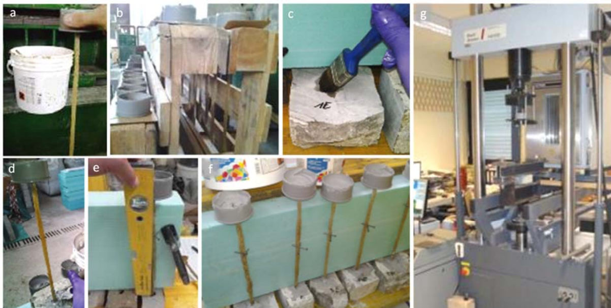
Slika 8.15: Priprava vzorcev za teste stika kamen-malta-vrvica: a) impregnirana in s kremenčevim peskom posuta steklena vrvica, vpeta v PVC čep, b) sušenje vrvic, c) nanos temeljno sprijemnega premaza (v primeru uporabe epoksi malte), d) vgradnja vrvic z izbrano malto, e) vertikalna namestitve vrvic v vzorcu, f) strjevanje vzorcev ter g) postavitve testa [255]
