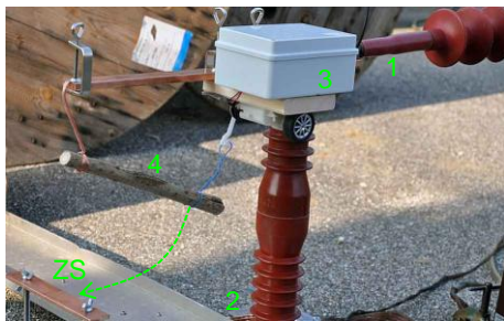
Slika 4: Fotografija naprave za simulacijo zemeljskega stika
