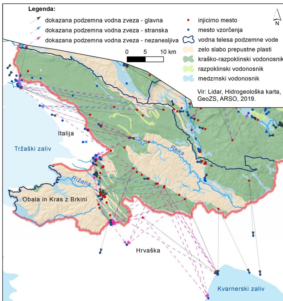
Sl. 10. Hidrogeološka karta z dokazanimi podzemnimi vodnimi zvezami za vodno telo podzemne vode Obala in Kras z Brkini.
