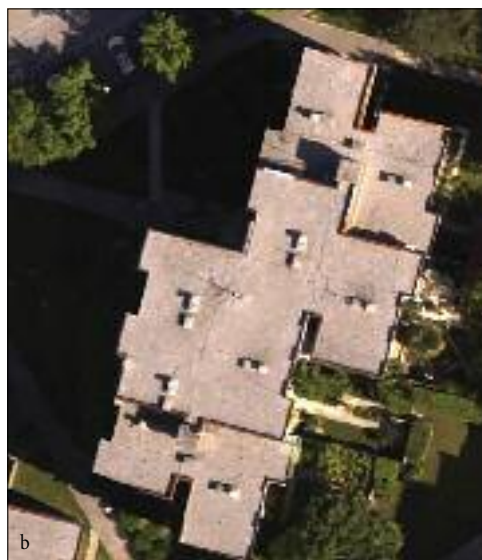
Slika 2: Shematični prikaz izdelave ortofota: (a) ob uporabi digitalnega modela reliefa (DMR) dobimo navadni (na primer državni ortofoto), (b) ob uporabi digitalnega modela površja (DMP) pa pravi ortofoto.
