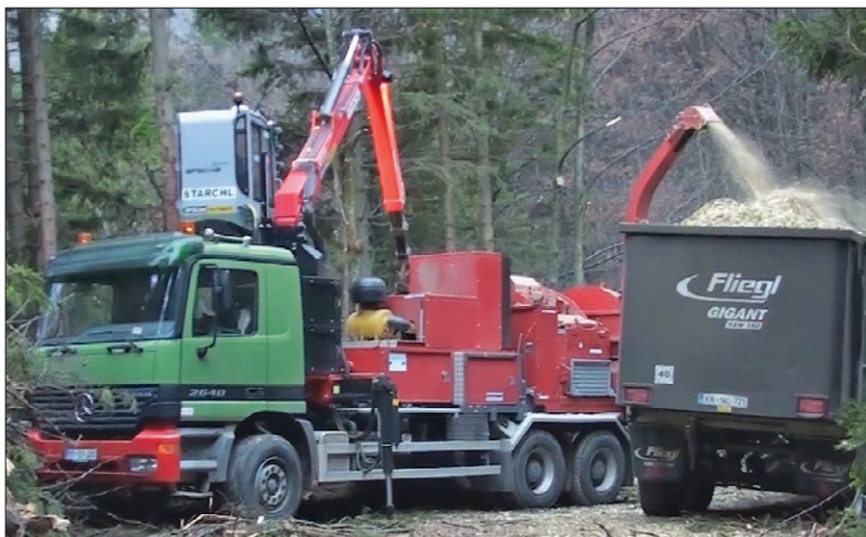
Slika 1: Izdelava sekancev in nakladanje na tovornjak (foto: M. Mihelič)
