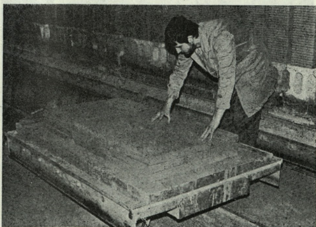
Slika 1. Vgrajevanje vmesnih izolacijskih slojev v vagončke za žganje keramičnih ploščic
