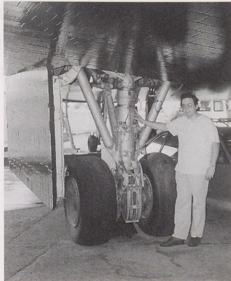
Velikost podvozja, kolesa in lopute za zapiranje podvozja si je moč zlahka predstavljati ob primerjavi z višino avtorja prispevka – 182 cm (desno).
