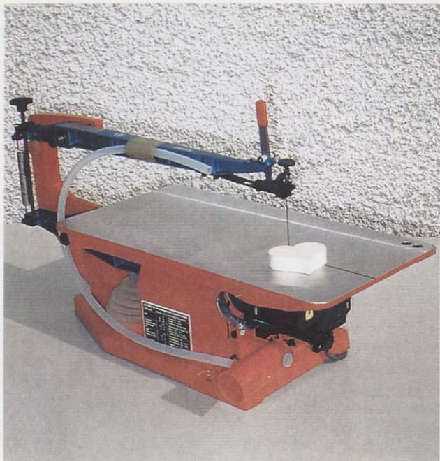
Slika 3. Pri žaganju z električno rezljačo zaradi izredno gladkega reza dodatno brušenje robov ni potrebno. Na sliki je srček, izrezan iz zgornjega dela naslonjala gugalnice.
