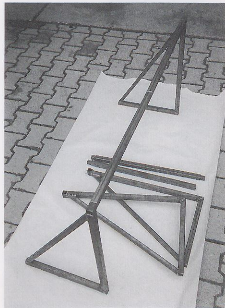
Slika 2. Gola sta narejena in sestavljena, zviri očiščeni in površina cevi razmaščena z bencinom. Sedaj je na vrsti barvanje s temeljno barvo.
