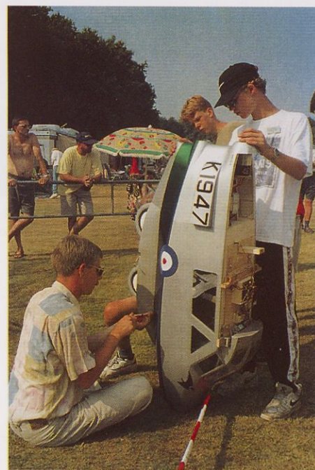
Pritrjevanje pokrova podvozja na zajetni trup, ki je zaradi brezrepe zasnove mnogo krajši kot običajno.
