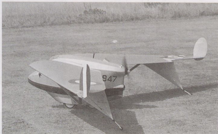
Smerni krmili na konceh kril sta zelo majhni, zato pa sta toliko večji dodatni smerni površini na spodnji strani krila, na katerih sta nameščeni stranski oporni kolesi.
