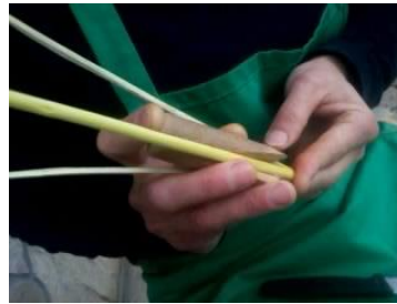
Slika 11: Potiskanje razcepnika (Vir: H. Košmerlj )
