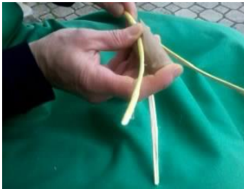
Slika 11: Potiskanje razcepnika (Vir: H. Košmerlj )
