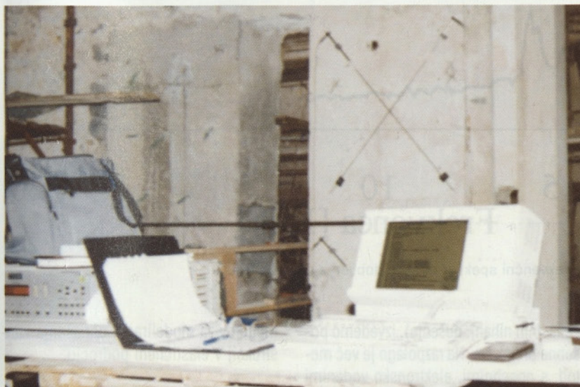
Slika 5: Castello di Sopra, Italija: preiskava nosilnosti kamnitega zidu in situ
