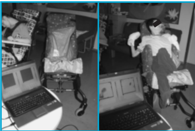
Sliki 3 a in 3 b: Merilna podloga in računalnik za merjenje porazdelitve pritiskov na sedežni enoti.
