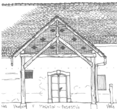
50. Vhodna lopa nad vrati magazina, od nekoč štirih na posestvu, edina, ki še stoji.
