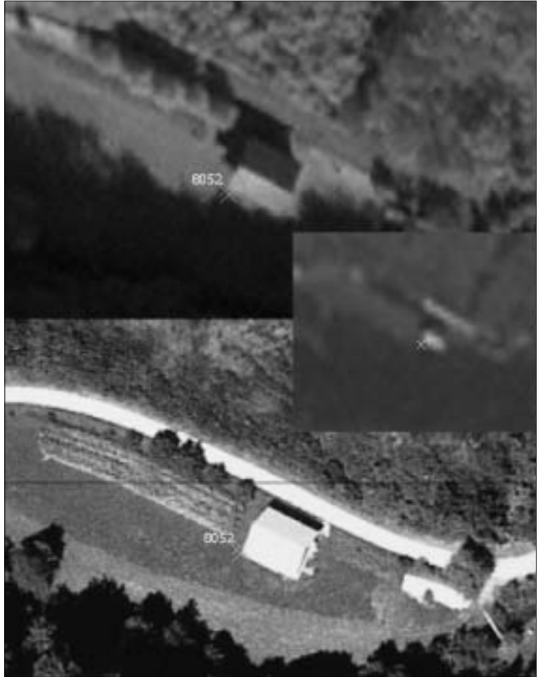
Slika 2: Prikaz oslonilne točke številka 8052 na 0,5-metrski prostorski ločljivosti DOF-a (spodnja slika), 1-m PAN (zgoraj) in 4-m MS (v sredini). Izseki iz Ikonosa © INTA Space Systems Inc, DOF © GURS.
