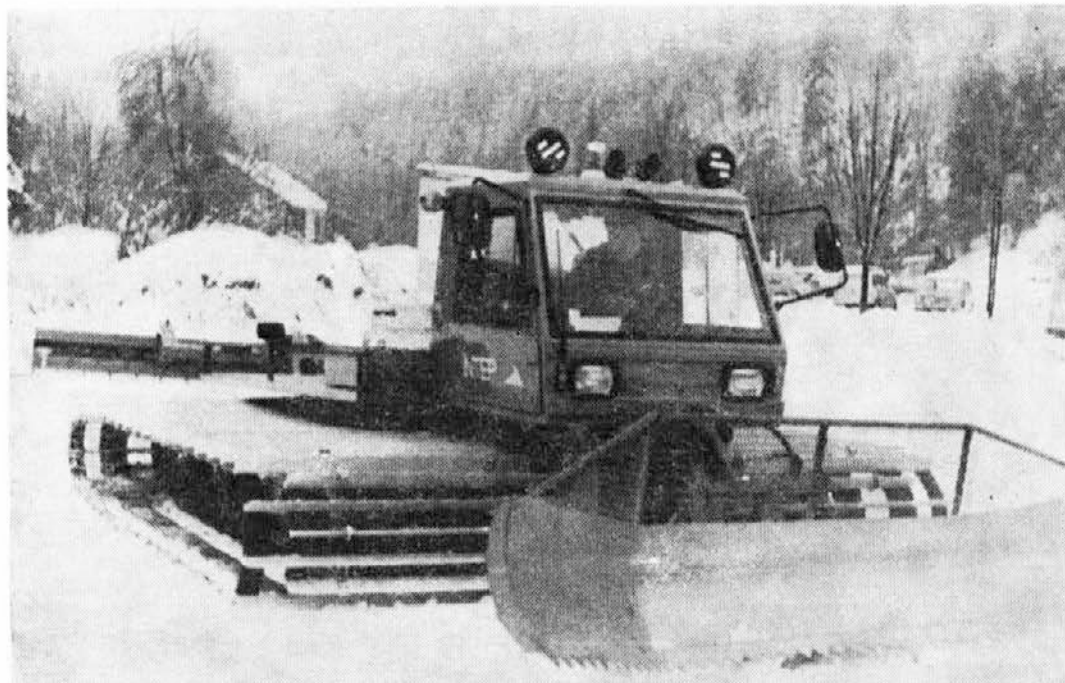
Teptalni stroj, ki so ga skonstruirali in izdelali v delavnicah Viatorja na Prevaljah iz pretežnega domačega materiala. Torej dvakrat domače: pamet in material. Čestitamo!
