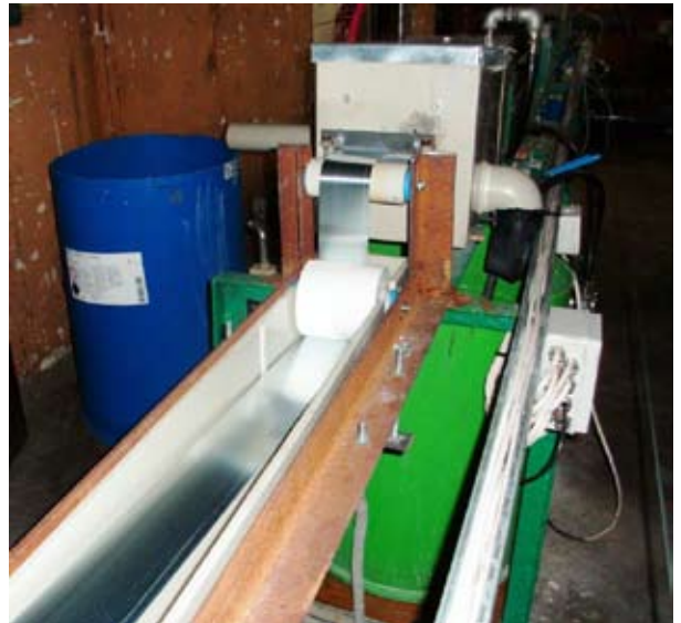
Pilotna linija za predpatiniranje pločevine
