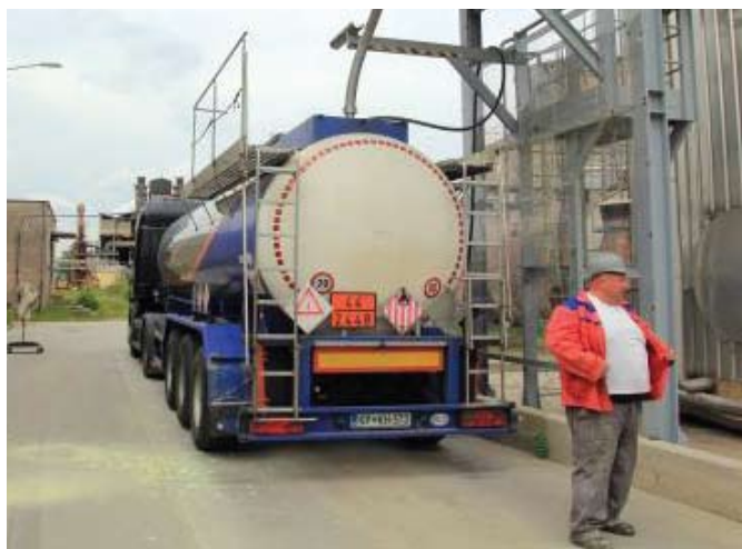
Voznik v Cinkarni priklopi avtocisterno na rezervoar in pretoči žveplo
