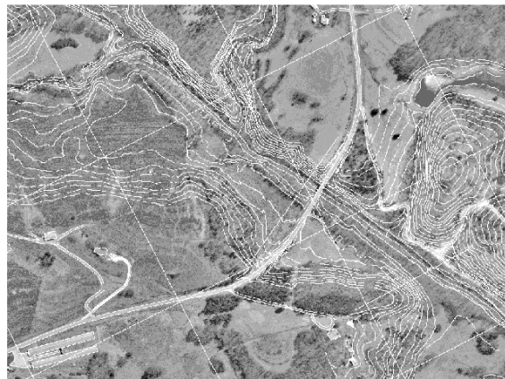
Sl. 11. Digitalni pravi foto načrt možnega poplavnega območja z obrisi, planimetrijo, lokacijami prerezov in koordinatno mrežo [14]
