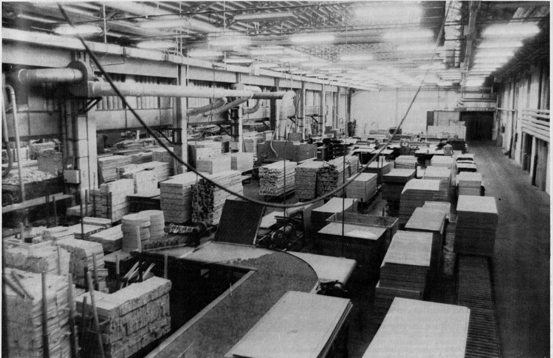
Predhodno pripravljene deli vratnih kril pred stiskanjem
