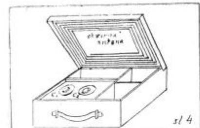
ćemo ugraditi okvir, a pored aparata ostaviti prostor za smeštaj slušalica i akumulatora (prenosni, takve konstrukcije da se ne izlije kiselina). Umesto akumulatora i anodne baterije možemo uzeti desetak džepnih baterija. Ako još upotrebimo cevi sa dve mrežice kao kod prenosnog prijemnika iz 12 i 13 broja od ove g., biće nam dosta 4—5 džepnih baterija.
