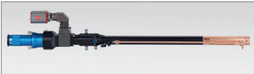
Slika 4. Laserska glava z dodajanjem prahu za notranje navarjanje cevi ventilov in drugih votlih elementov
