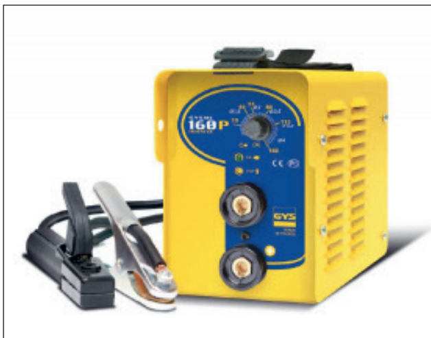
Slika 1. Inverterska varilna naprava za ročno obločno varjenje z oplasčeno elektrodo, ki se lahko priključi na omrežje z le 16-ampersko varovalko in tehta 4,2 kg. Z njo se lahko vari z jakostjo varilnega toka do 160 A.
