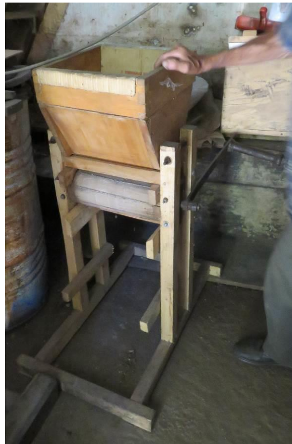
Slika 383: Ročni mlin za mletje brinjevih jagod. Tonetov izdelek.
