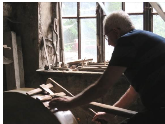
Slika 216: Brušenje skovane sekire na velikem brusnem kamnu, ki ga je nekoč gnalo vodno kolo, je bilo posebno delo, ki je dalo sekiri končni izgled in ostrino.
