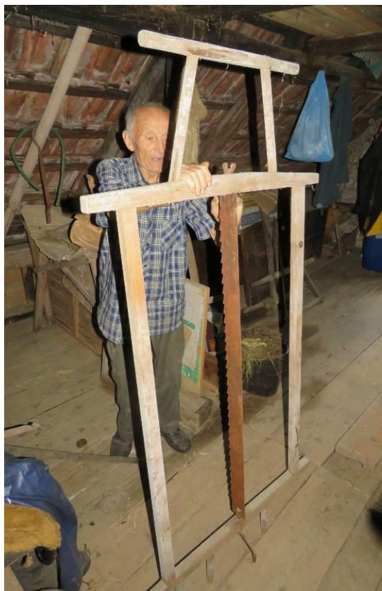
Slika 384: Za žaganje debelih plohov in gred za gradnjo hiš so uporabljali takole žago.
