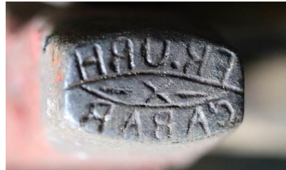
Slika 212: Nekoč so kovači označevali izdelke z vkovanimi znamenji, med vojnama pa že z vkovanimi žigi: FR.URH x ČABAR.
