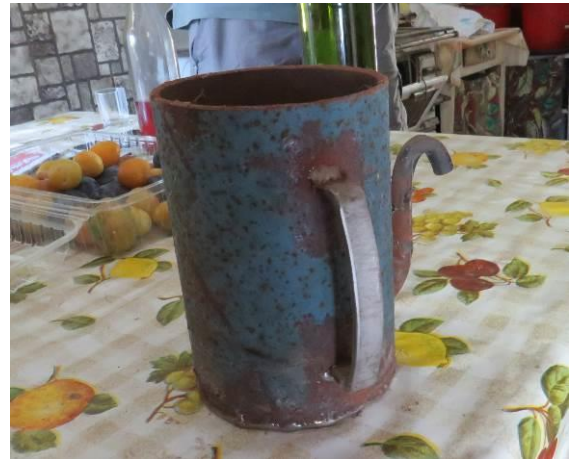
Slika 382: Posebna posoda za ločevanje brinove vode od olja. Voda se iztaka po zaviti cevki z dna posode.
