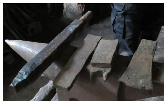
Slika 210: Branko kot izkušen kovač zna razložiti, kako iz železne palice (levo) postopoma izkuješ sekiro (desno).
