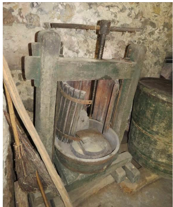
Slika 340: Stara stiskalnica za mošt iz jabolk in hrušk.
