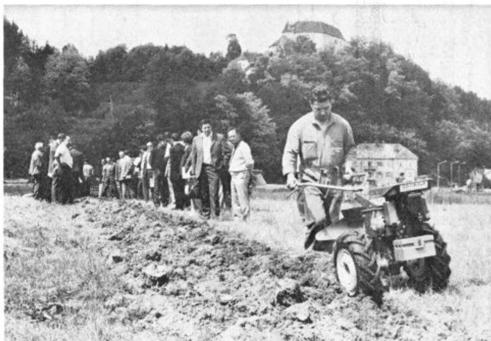
K traktorju se priključi plug za eno brazdo
