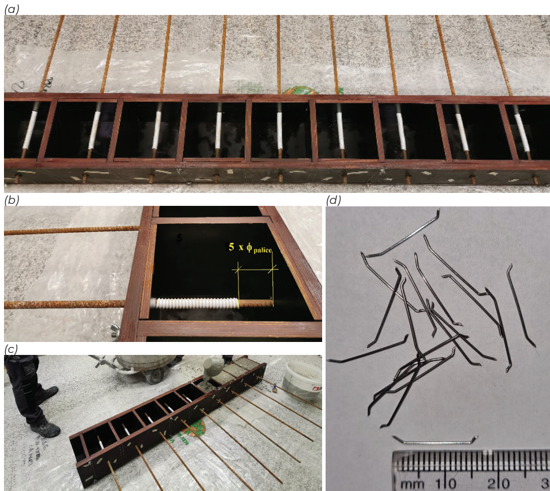
Slika 1. Prikaz izdelave preizkušancev za izvedbo preiskave izvlečne sile F_{izvl} in fotografija uporabljenih vlaken v mikroarmiranih betonskih mešanich.
