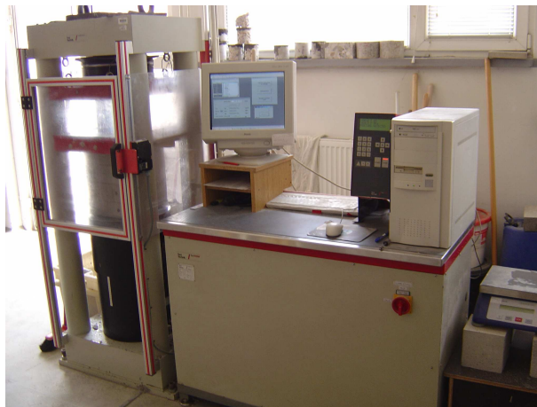
Slika 3.11 Preiskava tlačne trdnosti betona po standardu SIST EN 12390-3:2002, a) naprava za destruktivno preiskavo tlačne trdnosti, b) značilna porušitev betonskega vzorca.
