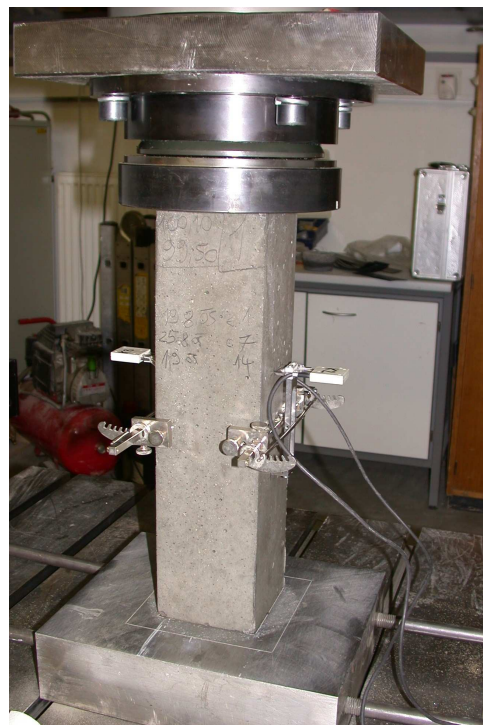
Slika 3.10 Določanje statičnega Youngovega modula, betonski vzorec dimenzij 100 × 100 × 400 mm. Figure 3.10 Determination of static elastic modulus – concrete specimen 100 × 100 × 400 mm.
