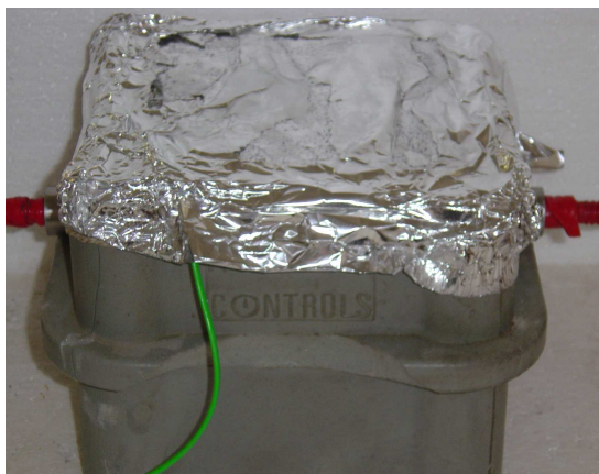
Slika 3.2 a) Kalup za določanje hitrosti prehoda ultrazvoka skozi preskušanec, prva faza razvoja b) primer krivulje hitrosti prehoda vzdolžnih ultrazvočnih valov skozi preskušanec s časom.
