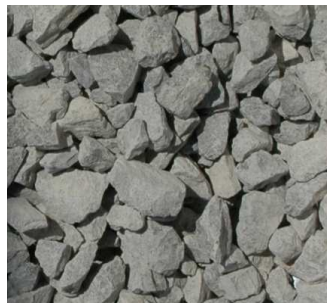
Slika 5.1 Drobljeni agregat apnenčevega izvora, a) frakcija 0 – 4 mm, b) frakcija 4-8 mm, c) frakcija 8 – 16 mm, d) frakcija 16 – 32 mm.
