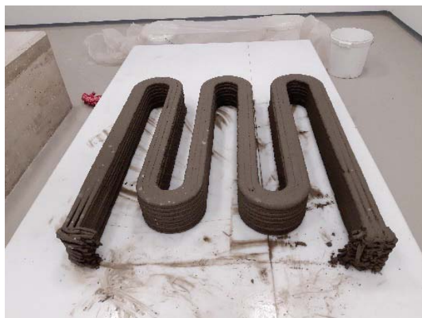
Slika 4. Prikaz vzorcev nastalih za medlaboratorijsko raziskavo RILEM-ovega tehničnega komiteja ADC (a) tiskanje vzorca za teste obstojnosti, in (b) izdelan vzorec za mehanske teste.
