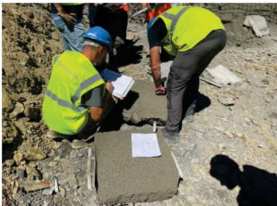
Merjenje razvoja tlačne trdnosti s penetrometrom
