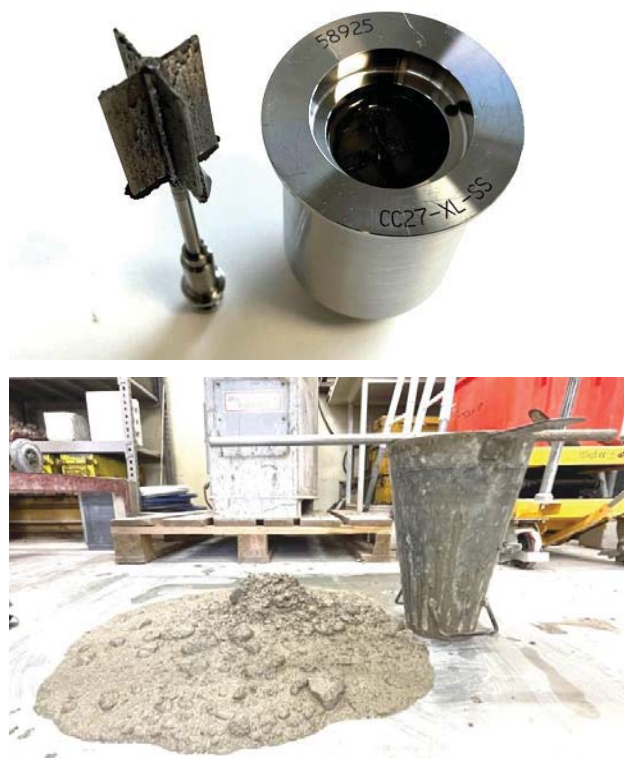
Slika 2: Uporabljene testne metode – Vaneova geometrija mešala reometra MCR 302 (levo zgoraj), posed (levo spodaj), hitrost prehoda ultrazvočnih p-valov (desno).
