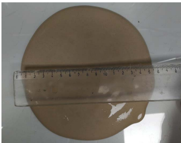
Slika 6: Razlez suspenzije kamene moke v vodi brez in z dodatkom PCE pri enaki količini vode
