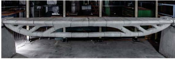
Slika 11: 3D tiskan nosilec, ki je oblikovan s tehniko topološke optimizacije. Material je uporabljen zgolj tam, kjer je to najino potrebno, kar privede do manjše porabe v natezni coni in večje količine materiala v tlačni coni (Vianqhem et al., 2020a).
