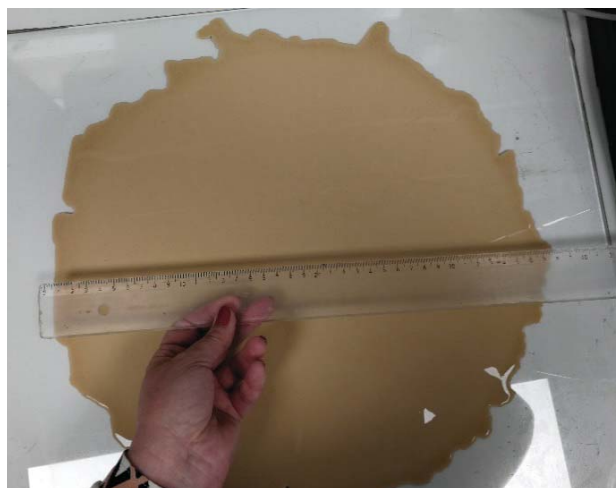
Slika 6: Razlez suspenzije kamene moke v vodi brez in z dodatkom PCE pri enaki količini vode
