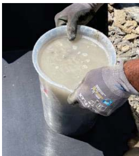
Vzorec za določanje vsebnosti vlaken v svežem MABB
