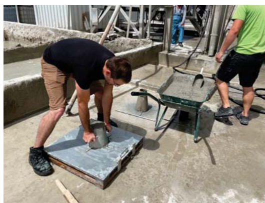
Meritve konsistence za določanje optimalne količine zamesne vode
