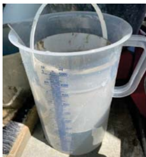
Merjenje volumna vzorca MABB z vodnim tehtanjem
