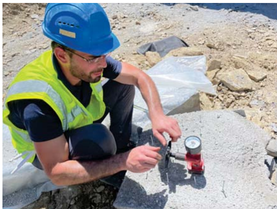
Merjenje razvoja tlačne trdnosti z žebljanjem
