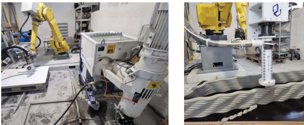
Slika 1. Primera 1K (desno) in 2K (levo) tehnologije 3DCP v podjetju Zevnik Lab.
