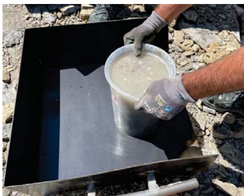
Merjenje količine vlaken v mikroarmiranem brizganem betonu
