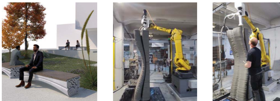
Slika 5. Primer ekstremnega 3D printanja klopi dolžine 2 m. Klop je bila narejena v 60 min. Oblikovanje Jurij Ličen, izvedba Zevnik Lab.
