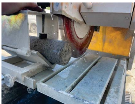
Rezanje jeder \varnothing 100 mm na višino 100 mm
