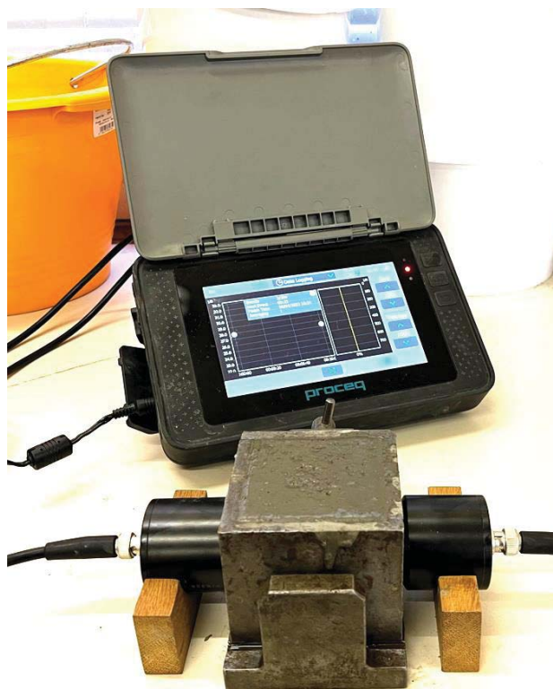
Slika 2: Uporabljene testne metode – Vaneova geometrija mešala reometra MCR 302 (levo zgoraj), posed (levo spodaj), hitrost prehoda ultrazvočnih p-valov (desno).
