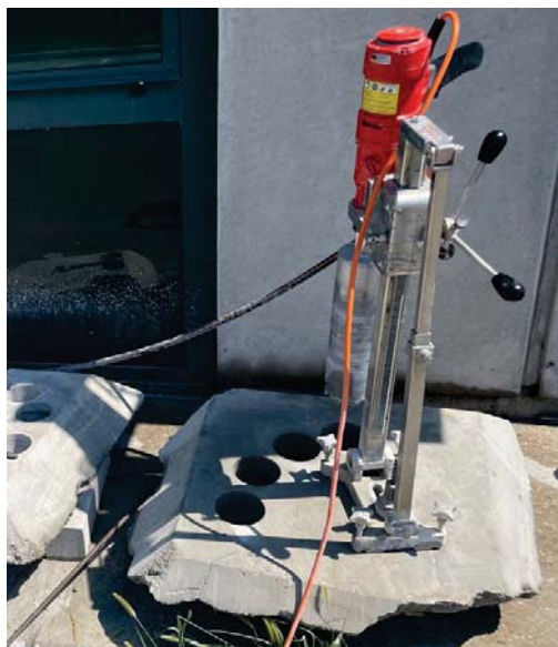
Vrtanje jeder \varnothing 100 mm iz kalupa
