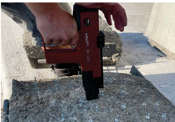
Meritve zgodnjih trdnosti z žebljanjem
