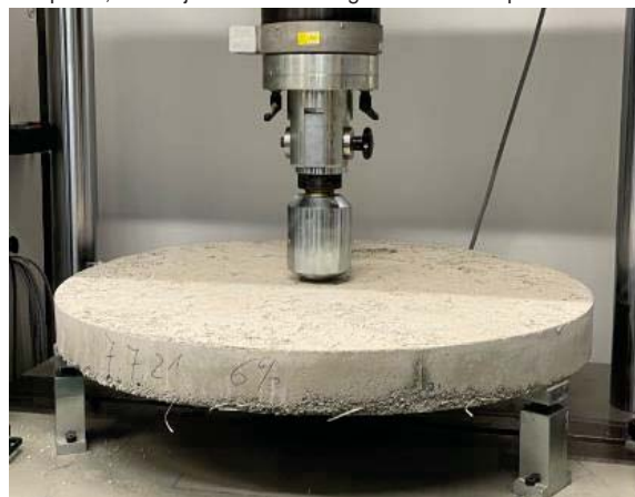
Preizkus žilavosti mikroarmiranega betona po ASTM C1550
