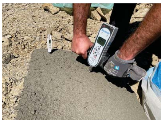
Meritve zaodnih trdnosti s penetrometrom
