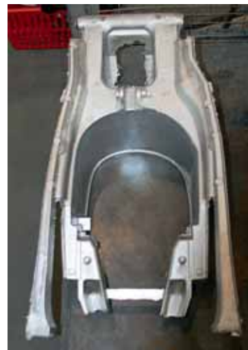
Prototip vilic za BMW-jev motocikel
