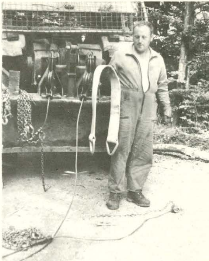
Pas, s katerim zmanjšamo poškodbe na gozdnem drevju, bi moral postati sestavni del opreme vsakega gozdarskega traktorja. Pas je domač izdelek. Vse informacije dobite v gozdarskem sektorju v Slovenj Gradcu. Foto: A. Klemenšek
