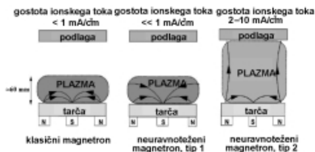
Slika 4: Silnice magnetnega polja pri navadnem (t. i. klasičnem) magnetronu in dvema neuravnoteženima magnetronoma. Pri zadnjem sega plazma globoko v komoro.
