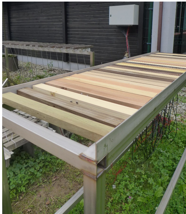
Slika 1: Izpostavitve vzorcev na terenskem polju Oddelka za lesarstvo
