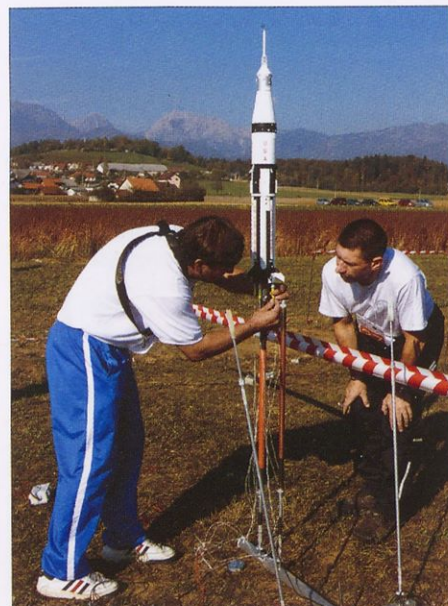
Vladimir Čipčić namešča električne vžigalnike v šobe motorjev makete saturn 1b.
