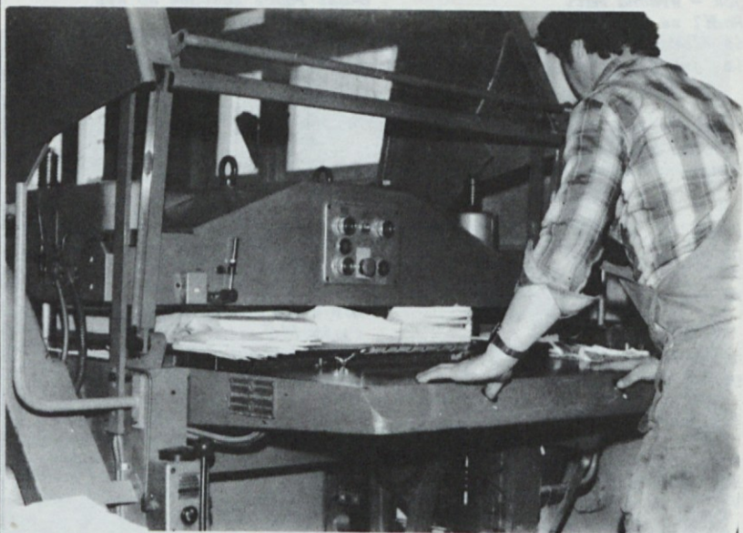
Izsekovanje formatnega papirja za izdelavo kuvert
