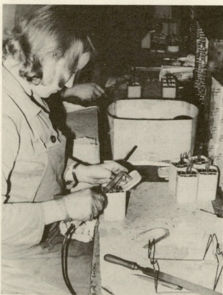
Zaključek montaže baterij 4R25
