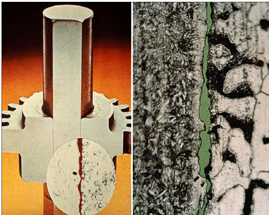
Slika 2. Mikroskopska povečava stika površin v krčnem nasedu
