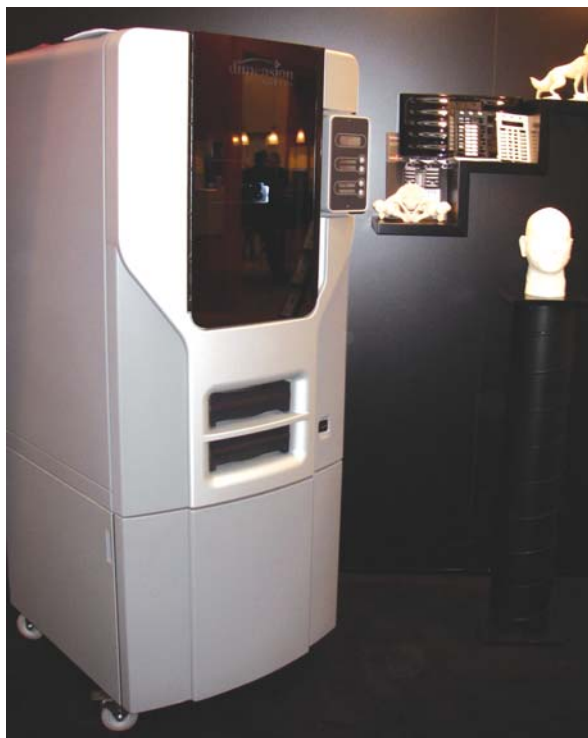
»Tiskalnik« Dimension podjetja Stratasys, ki deluje po postopku FDM
