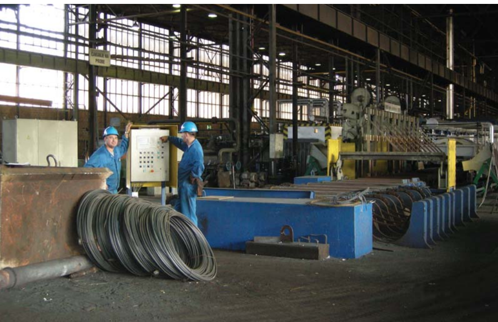
Obnovljene konti peči za toplotno obdelavo v valjarni
