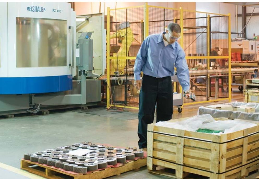
Slika 8: Zajem podatkov s črtne kode z ročnim čitalnikom
