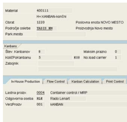
Slika 7: Matični podatki o kanbanu v SAP ERP
