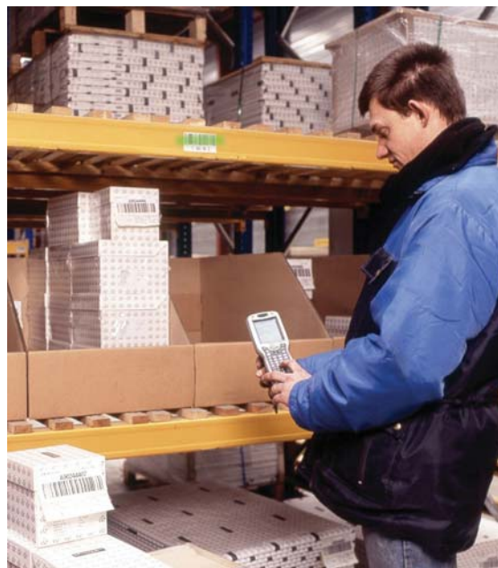
Slika 9: Robustni ročni računalnik za zajem podatkov s črtne kode
