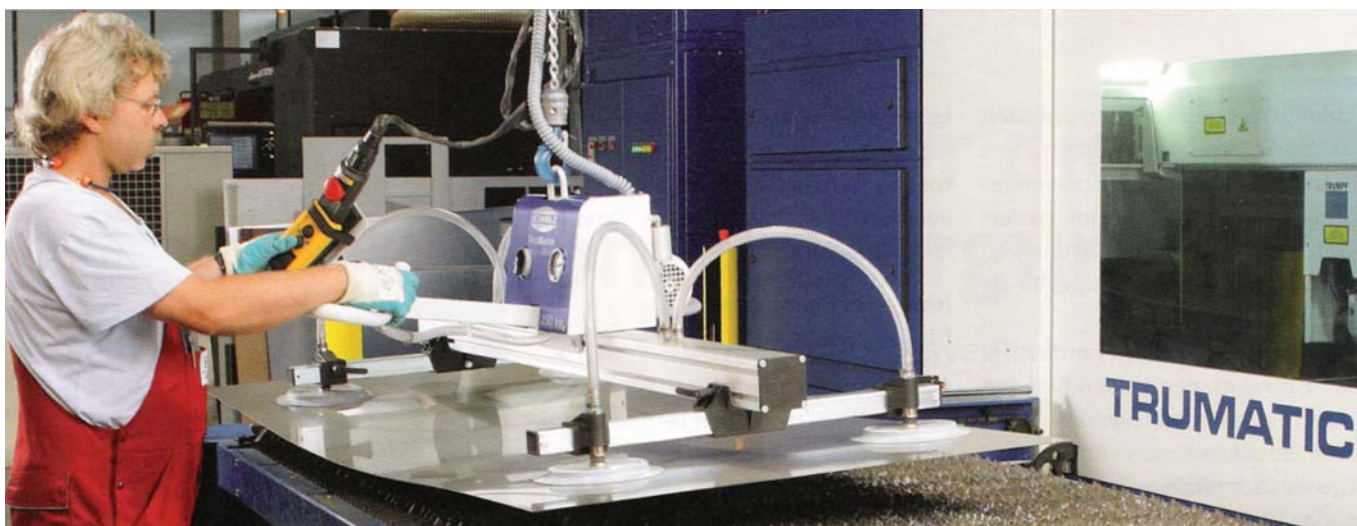
Naprava VacuMaster Basic pri vstavljanju pločevinastih obdelovancev mase 30 kg v stroj za lasersko rezanje.
