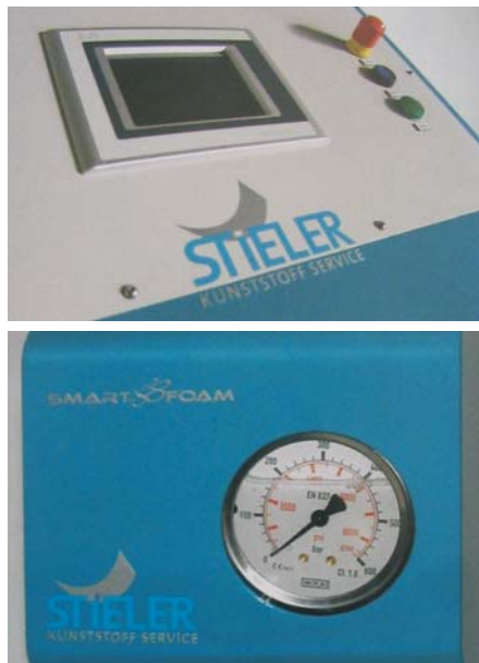
Slika 4: Stiel® Smart Foam, enota za dovod plina in merilnik hitroodzivnega regulacijskega ventila
