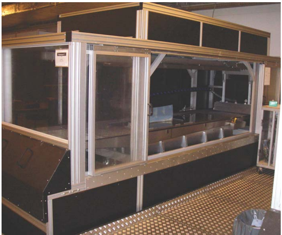
Mammoth stereolitography – naprava v Materialisovem centru v Leuvenu, Belgija
