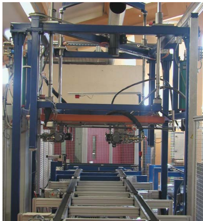
Slika 3: Postaja s štirimi kleščami in paletni transportni sistem
