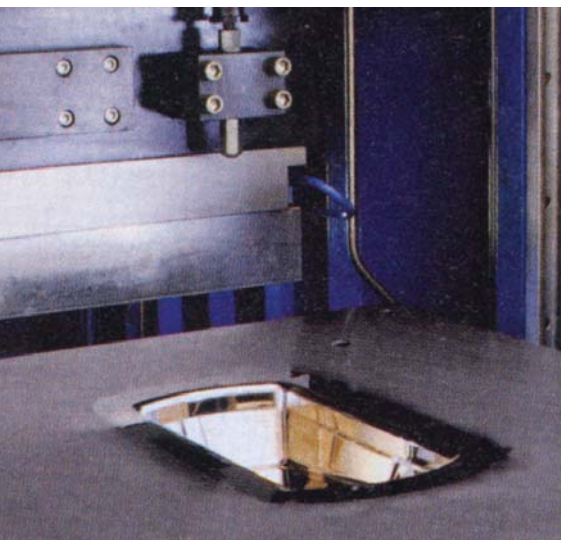
Slika 2: Majhni izdatki za orodje so predvsem posledica tega, da potrebujemo le eno polovico orodja, in sicer matrico.
