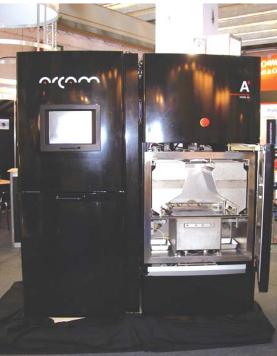
ARCAM A2 – največji in najhitrejši sistem za izdelavo kovinskih izdelkov
