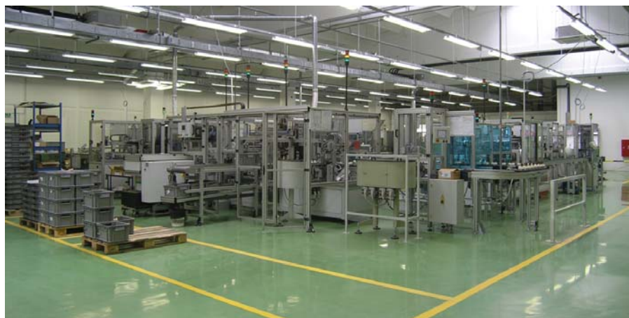
Na avtomatizirani liniji lahko sestavljajo tri tipe agregatov v številnih različicah, prilagojenih zahtevam kupca, čas izdelave pa je za več kot polovico krajši kot na stari liniji za sestavljanje.
