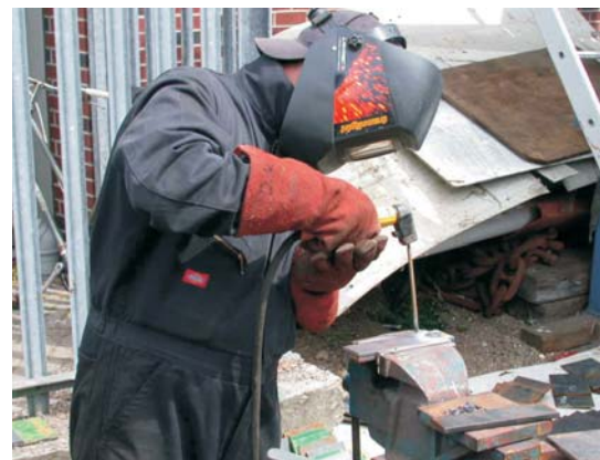
Slika 2a: Prikaz izvedbe talilnega točkovnega varjenja z oplaščeno elektrodo
