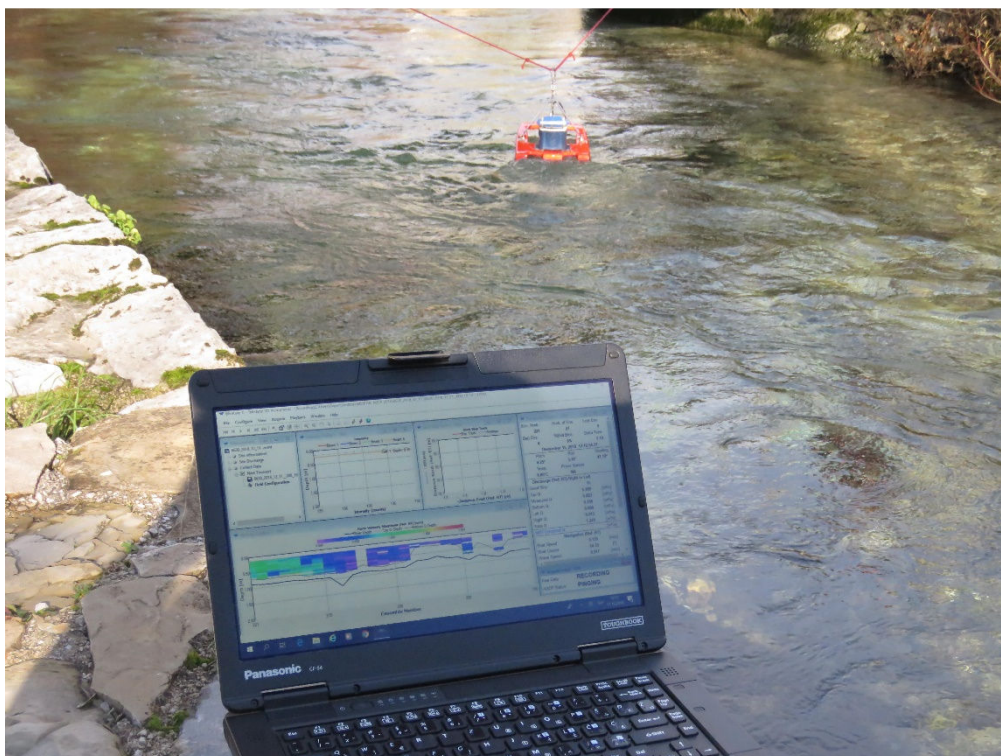
Slika 2. Izvajanje meritev pretoka z ultrazvočnim Dopplerjevim merilnikom hitrosti toka na območju izvira Hubelj (december 2018)
