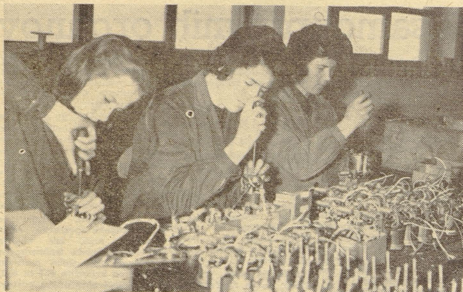
Delavke Anica Šturm, Milka Valentinčič in Ivanka Kežnar montirajo za sedaj elektromotorje še na pomožni liniji, dokler ne bo stekel nov tekoči trak
