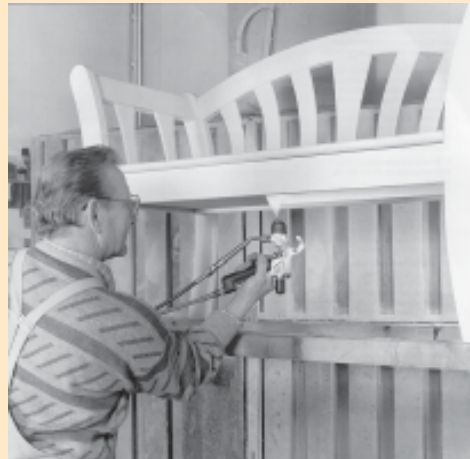
□ Slika 4. Brizganje z "Air Coat" ročno pištolo
