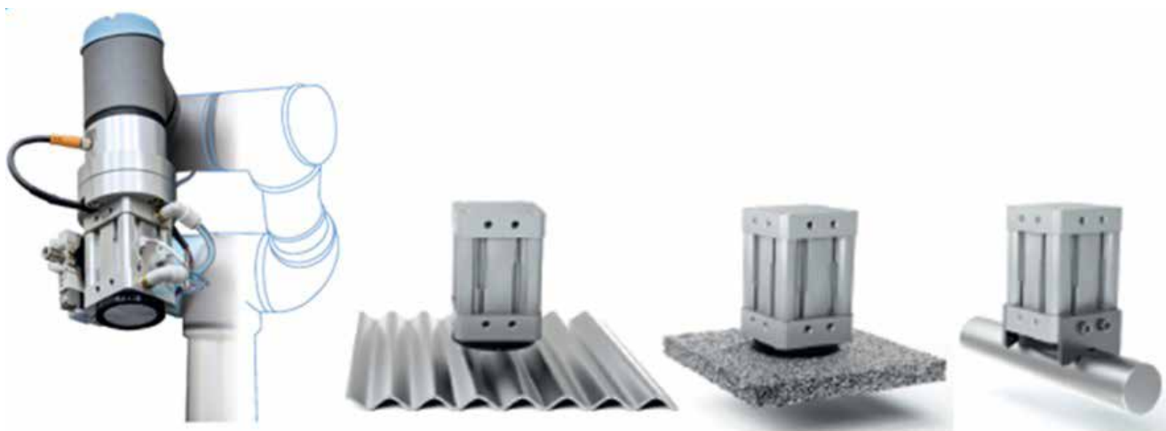
Slika 1: UR + certificiran komplet magnetnega prijemala serije MHM
