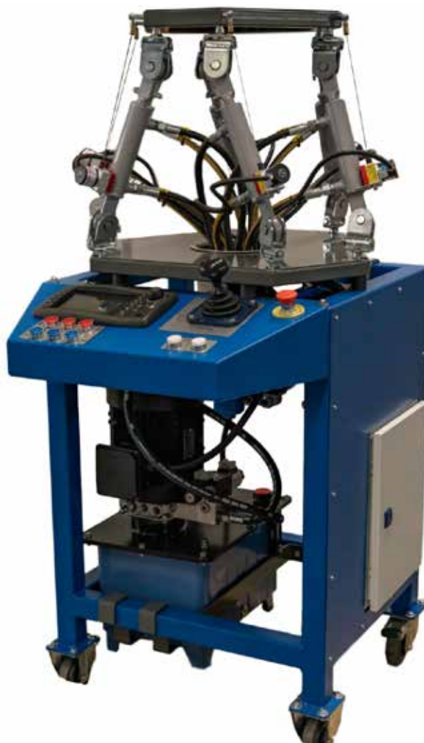
Slika 8 : Končan prototip hidravlične Stewartove ploščadi (685 x 844 x 1505 mm)
