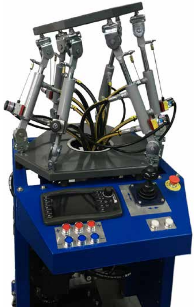
Slika 9 : Hidravlični prototip Stewartove ploščadi (685 x 844 x 1600 mm)
