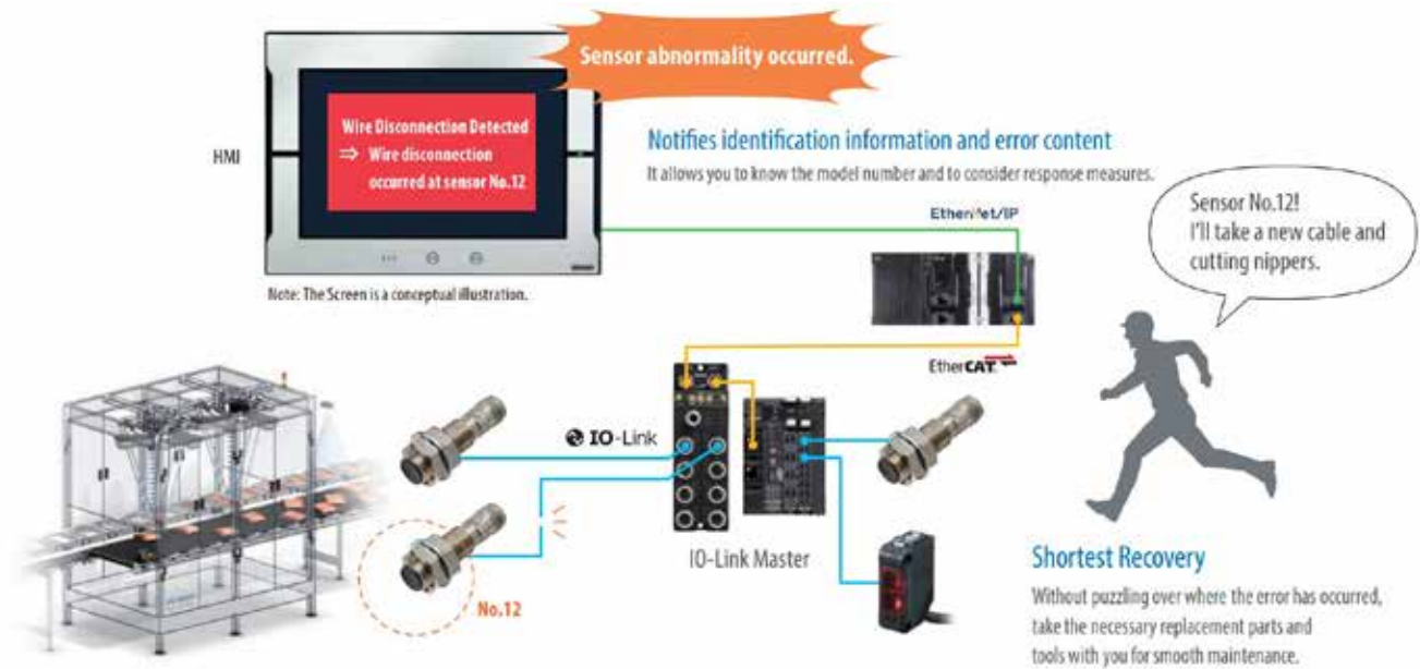
Slika 2 : Signalizacija odklopljenega senzora št.12
