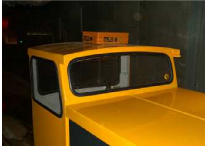
Slika 11: Slika DTN podatkovne mule montirane na turističnem vlakcu v Postojnski jami z uporabo magnetnega nosilca
