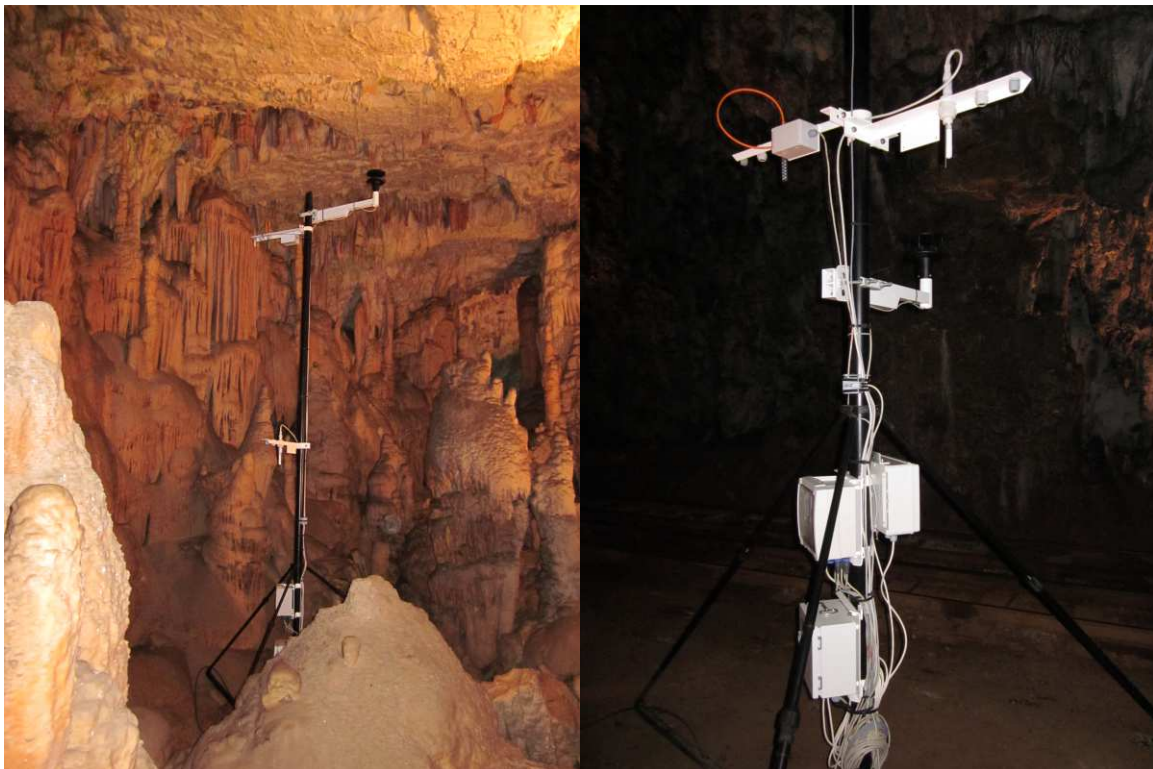
Slika 7: Slike montaže senzorjev na prenosne merilne stolpe (levo na lokaciji »Lepe jame«, desno na lokaciji »Vodopad«).
