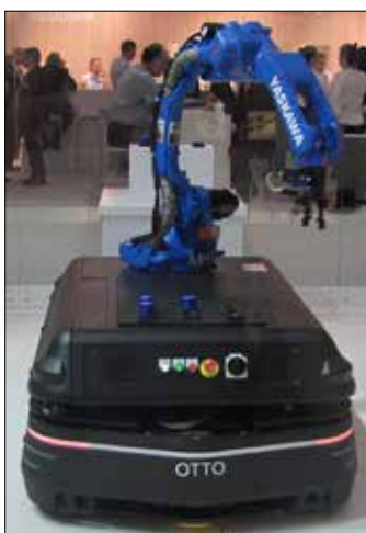
Slika 15. Avtonomno vodeni vozički v procesih strege in montaže (vir: Šimic)
