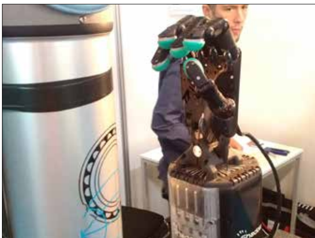
Slika 13. Inteligentne robotske roke, opremljene s senzorji za občutenje objektov (vir: Shadow Robot Company)
