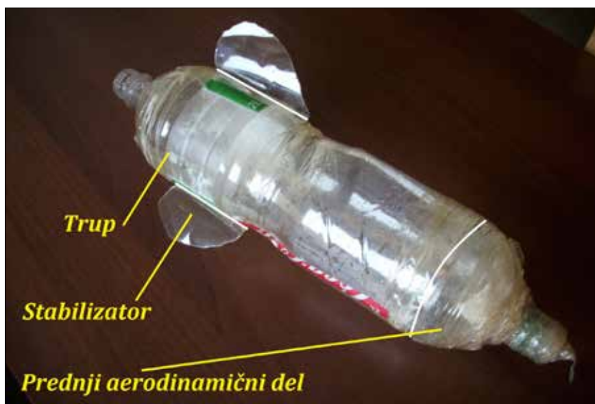
Slika 2. Glavni gradniki vodne rakete
