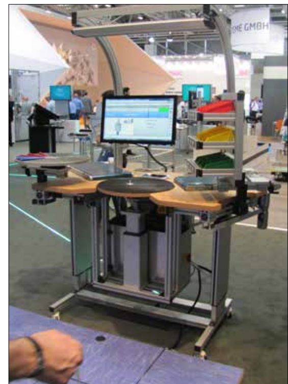
Slika 6. Samoprilagodljivo ročno montažno mesto z naprednimi pripomočki (vir: Šimic)
