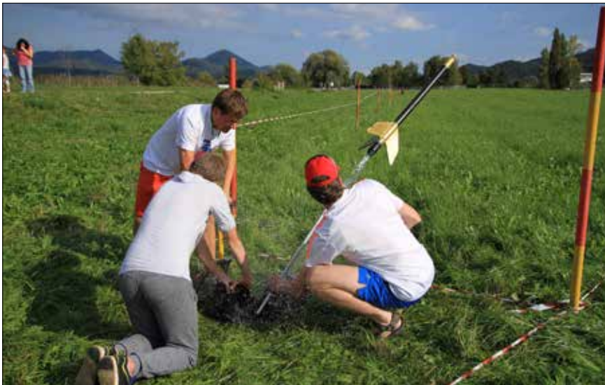
Slika 3. Z daljšo vodno raketo in stabilizatorji dosežemo večjo stabilnost leta vodne rakete
