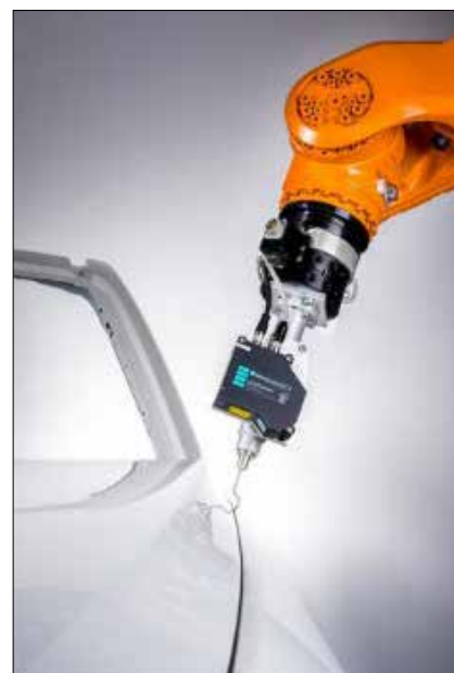
Slika 2. Kontrola procesa nanosa tesnilne mase z uporabo strojnega vida (vir: VMT)
