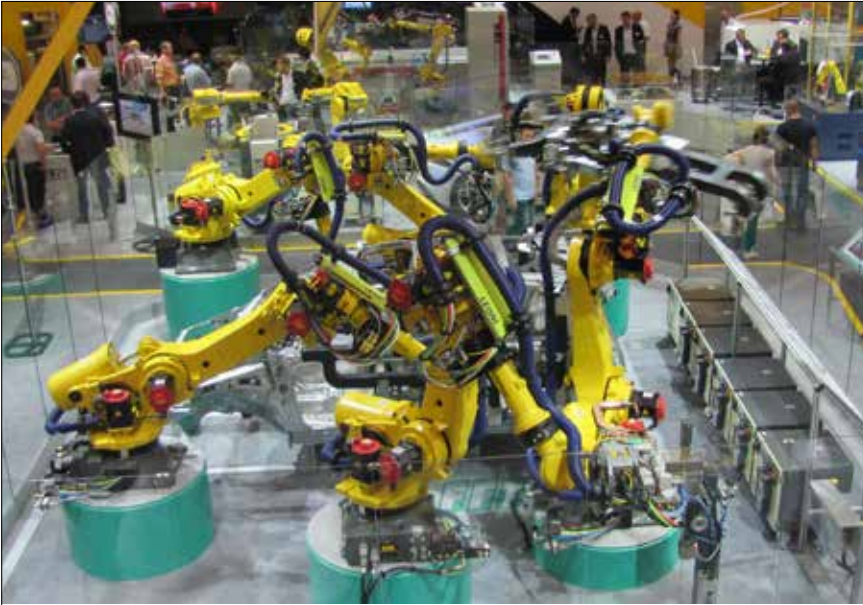
Slika 10. Varjenje avtomobilskega ogrodja z robotsko celico (vir: Šimic)
