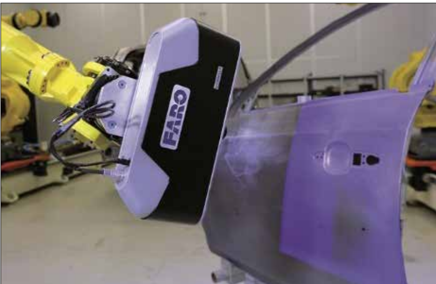
Slika 4. Skeniranje za digitalizacijo 3D-objektov (vir: Faro)
