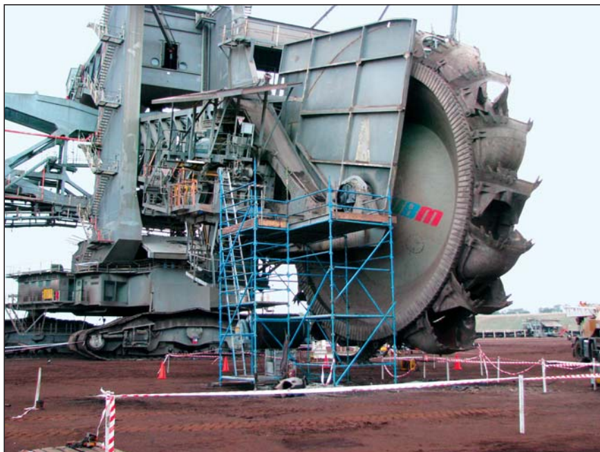
Slika 3. Frezalno kolo Dregerja 16 z dnevno kapaciteta izkopa 60 000 t
