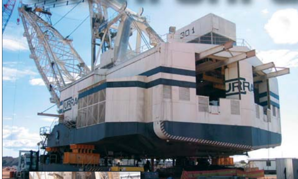
Vzdrževanje 3500 ton težkega Dragline bagerja za dnevni kop premoga s pomočjo Enerpac sinhronnega dvižnega sistema, v Avstraliji.
