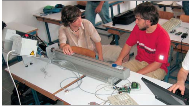
Slika 3. Pozicionirna enota, mehatronsko učilo podjetja PS Logatec
