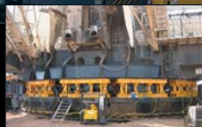
Vzdrževanje 3500 ton težkega Dragline bagerja za dnevni kop premoga s pomočjo Enerpac sinhronnega dvižnega sistema, v Avstraliji.
