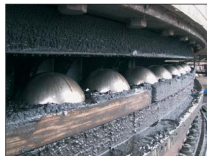
Slika 2. Kotalni ležaj vrtljive nadgradnje bagerja s premerom 15,2 m in 177 kroglami (s premerom 200 mm in težo 32 kg)
