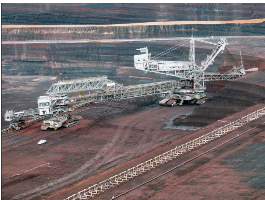
Slika 1. 5 000 t težek bager za dnevni kop premoga v Loy Yangu – Avstralija, z dolžino okoli 200 m in višino okoli 55 m
