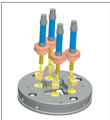
Slika 10. Kontakti v glavi kontrolne naprave
