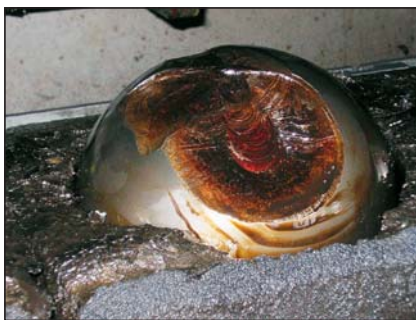
Slika 4. Poškodovana krogla kotalnega ležaja
