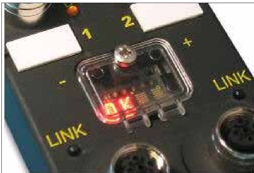
Slika 2. Diagnostični prikazovalnik na modulu
