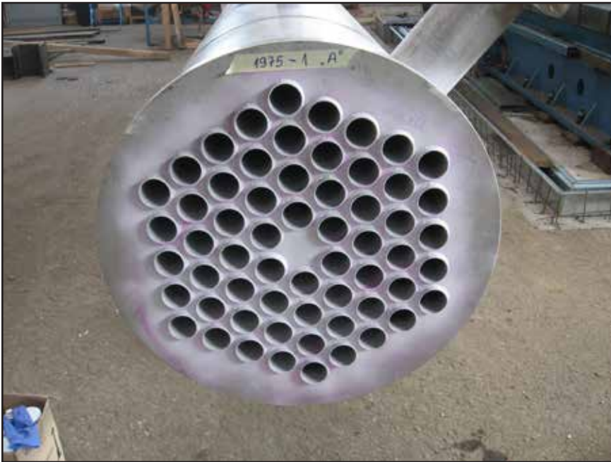
Penetrantska preiskava cevne stene toplotnega izmenjevalnika
