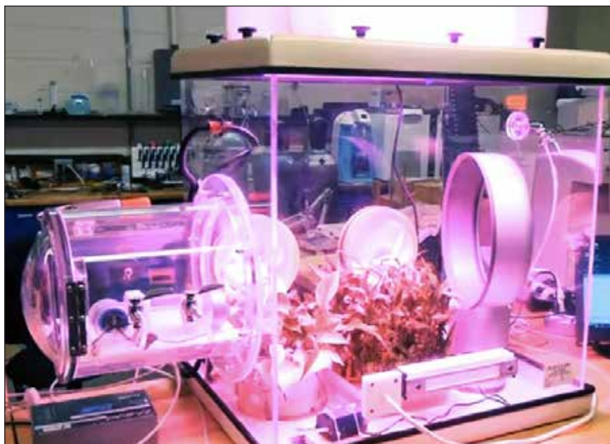
Razvojni laboratorijski inkubator za iskanje načina čiščenja CO 2 iz ozračja
