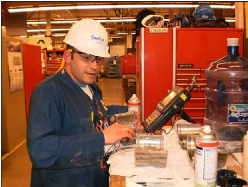
Ultrazvočna preiskava v tuji elektrarni
