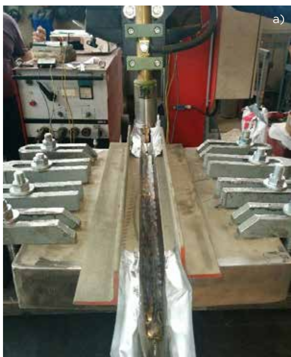
Slika 3 : Varjenje vzorca med izvedbo WPQR (a) in makro obrus zvara (b)
