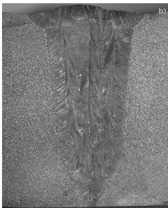
Slika 3 : Varjenje vzorca med izvedbo WPQR (a) in makro obrus zvara (b)
