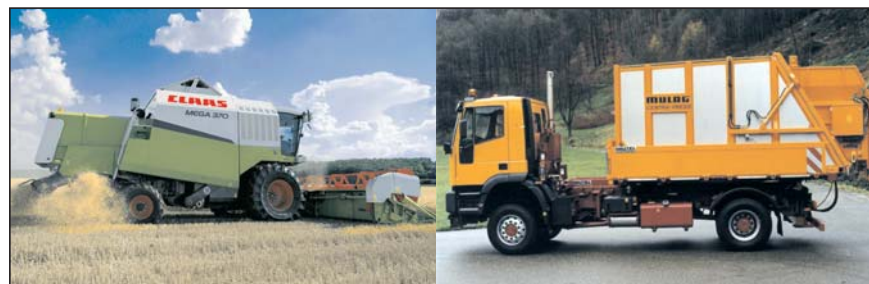
Slika 2. Primera uporabe. Merilniki so vgrajeni v hidravlične cilindre za manipulacijo z vrati in kontejnerjem in v cilindru za nastavitev višine kose kombajna.
