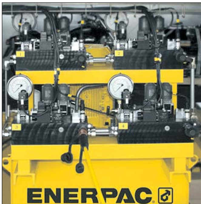
Enerpac je s svojim hidravličnim sinhronim dvžnim sistemom ponudil rešitev horizontalne izravnave podpornega križa
