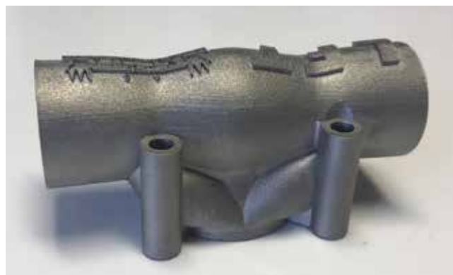
Slika 10 : Kovinsko natisnjeno, topološko optimirano ohišje ventila (86 mm x 44 mm x 41,5 mm)
