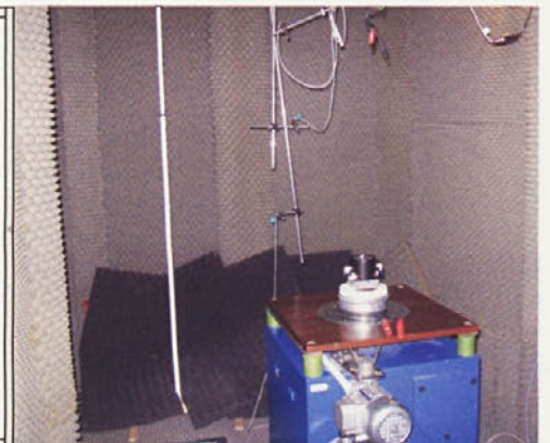
Slika 2: Gluha soba s poljem merilnih mikrofонов (desno) in shematski prikaz (levo)
