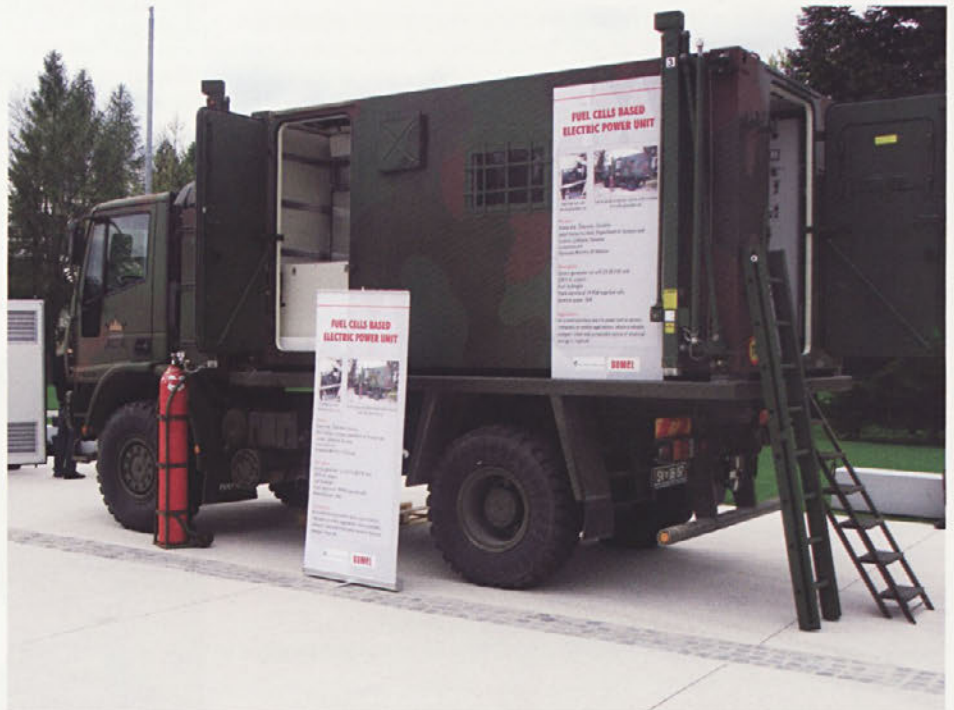
Namensko vojaško vozilo z vgrajenim agregatom na gorivne celice
