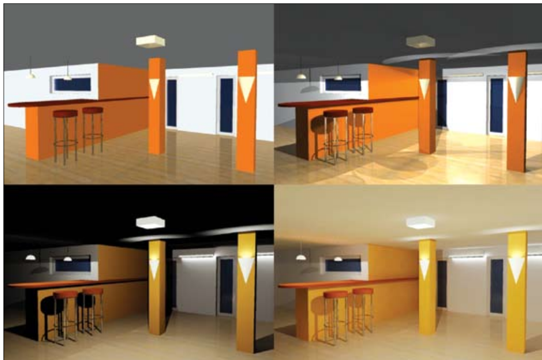
1. vrsta: način osvetlitve Generic (iz prejšnjih različic AutoCAD-a): prednastavljena luč in uporabniške luči. 2. vrsta: fotometrični način osvetlitve: brez upoštevanja in z upoštevanjem odboja svetlobe.
