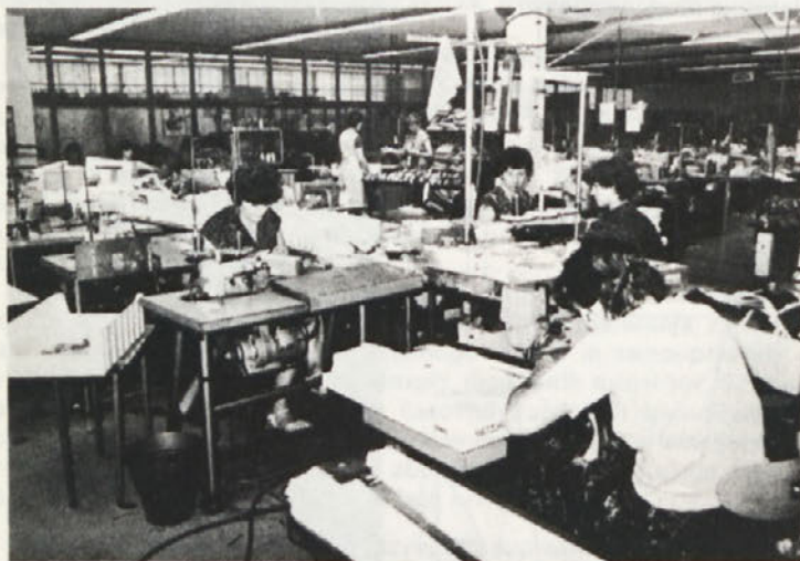
2. Predmontaža: sortiranje in priprava delov za šivanje.
