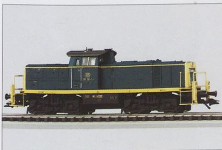
Kovinski model dizelsko-hidravlične lokomotive serije V 90 z motorjem C sinus in dekoderjem mfx (Märklin)
