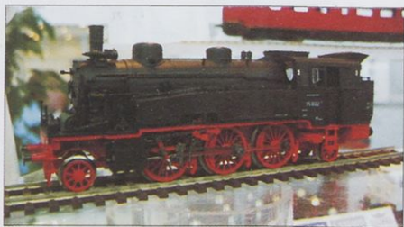
Model parne tenderske lokomotive DB 75 proizvajalca Liliput v merilu 1 : 87 (H0) za digitalni sistem vodenja DC in AC
