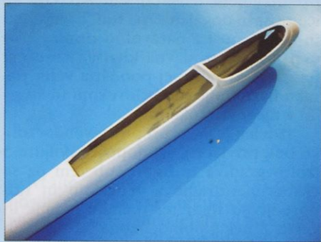
Popravljen in pobarvan trup na zunanizgleda brezhibno. Masa se je povečala za 17 g, kar glede na obseg poškodb ni veliko.
