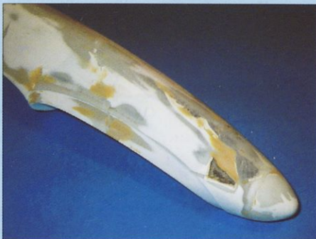
Popravljen trup prebrusimo z zunanje strani in napake prekitamo s poliestrskim kitom. Trup je pripravljen na nanos kita za brizganje.
