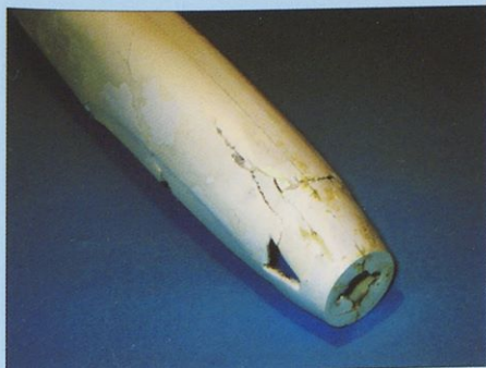
Največ škode je na trupu naredil elektromotor, ki ga je ob udarcu potisnilo v notranjost trupa.
