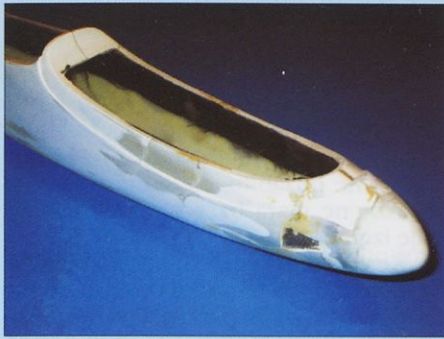
Po grobem čiščenju laminat na nekaj mestih začasno zlepimo s sekundnim lepilom. Trup po brušenju z notranje strani okreplimo z ogljikovo tkanino in čez diagonalno položimo nov sloj 50-g tkanine.
