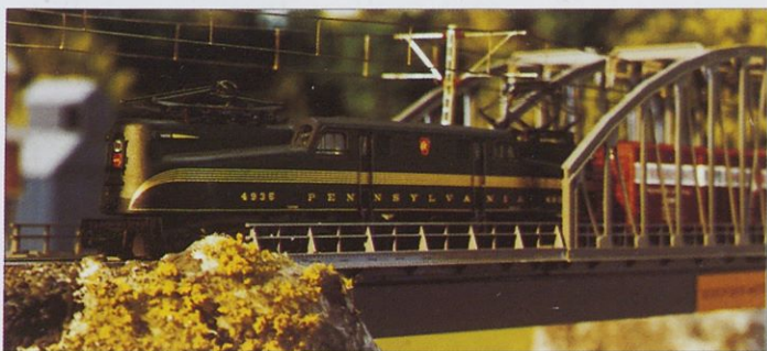
Märklinov model večnamenske električne lokomotive tipa GG-1 v merilu 1 : 87 (H0). Poganja jo motor z vrtljivim obodom (sistem Faulhaber). Model ima vgrajen digitalni zvočni dekodekoder z veliko dodatnimi funkcijami in bo na voljo za sistema vodenja AC in DCC.
