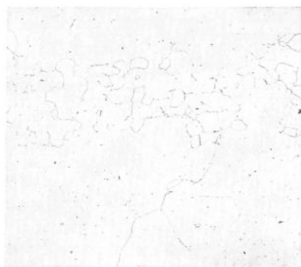
Slika 13 — 100 × Naraščanje zrna v razogljčeni coni pri 800° C
