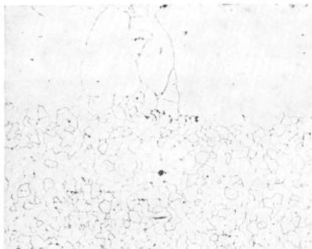
Slika 14 — 100 × Naraščanje zrna v razogljiveni coni pri 750° C
