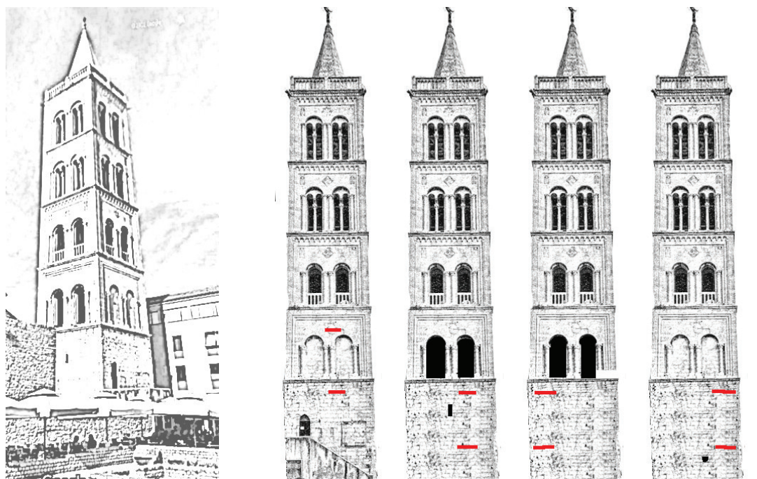
Slika 1. Levo: pogled na zvonik katedrale sv. Anastazije v Zadru, desno: rdeče okvirno označena merilna mesta, od leve proti desni: JV, JZ, SV in SZ fasada.
